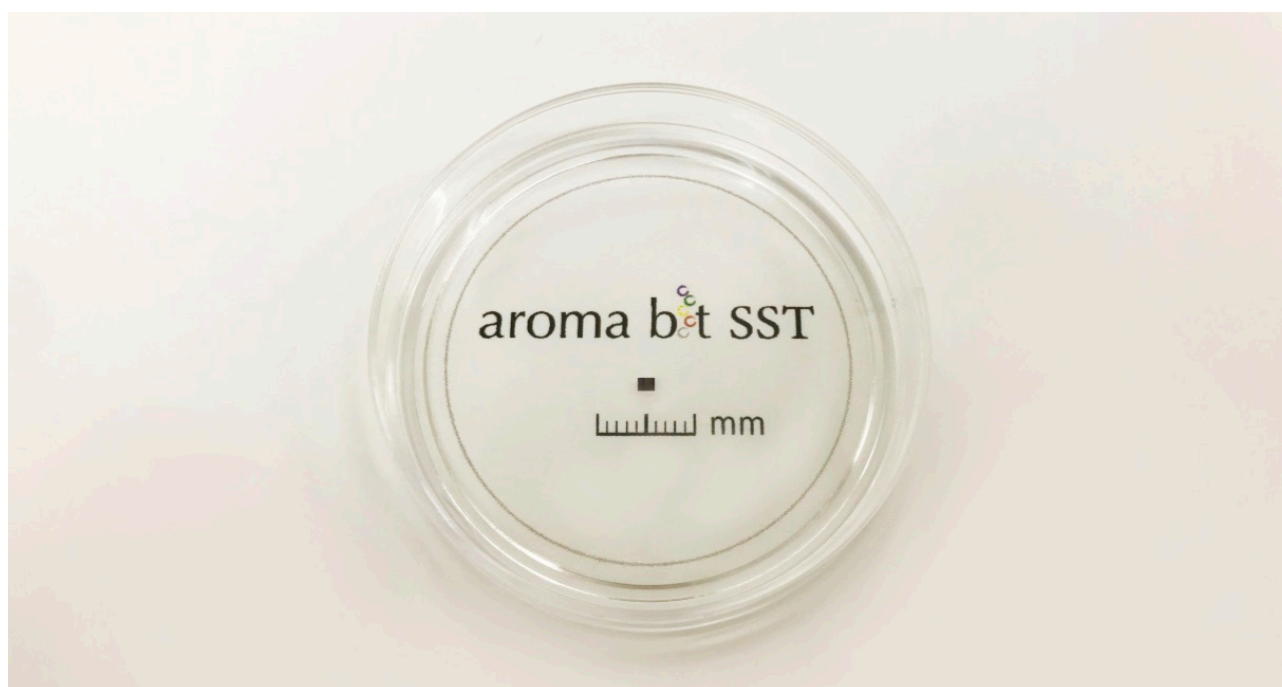
図 4：「犬の鼻」と同等の約 1, 200 素子を有する約 1 ミリ角のシリコン CMOS 型ニオイセンサー素子の写真
